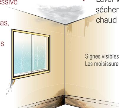
Signes visibles d'humidité excessive et de moisissures. Les moisissures peuvent aussi se trouver à l'intérieur des murs.
